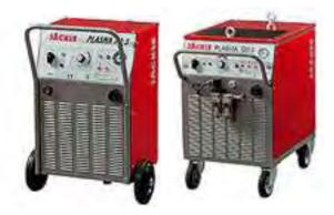
>> Las máquinas de corte por plasma Modelo 70S y 120S con regulación continua, tienen la ventaja de la **tecnología de control por tyristores**, de tal forma que la corriente de corte mantiene un **nivel constante** con independencia de las variaciones de tensión en la línea, de la longitud del arco o de la longitud de los cables, lo cual garantiza unos **resultados de** corte estables.
