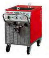
>> Apto para antorchas de plasma refrigeradas tanto por aire como por agua; con unidadde refrigeración KG1 opcional. Control por transistores: serie ajustable de corriente de corte. Gas plasma: aire comprimido. Sistema de ignición: HF. Conexión central para la antorcha de plasma (Euroconector). Control térmico, ventilador silencioso. Protección de sobrecarga térmica. Conector y sistema de protección antipolvo. Indicador S. Conector para control remoto y apto para descarnar.
